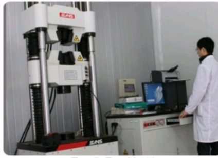
Tensile Test Machine
